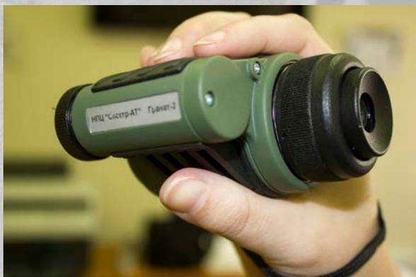
Для поиска и визуализации местоположения портативных скрытых телевизионных систем наблюдения, например камер, спрятанных в стене или мебели, в пуговице или значке, в портфеле или сумке, с обычным объективом или микрообъективом (типа pin-hole), включённых или выключенных, передающих изображение по проводам или по радиоканалу, эксплуатируемое в условиях умеренного климата в закрытых помещениях.
