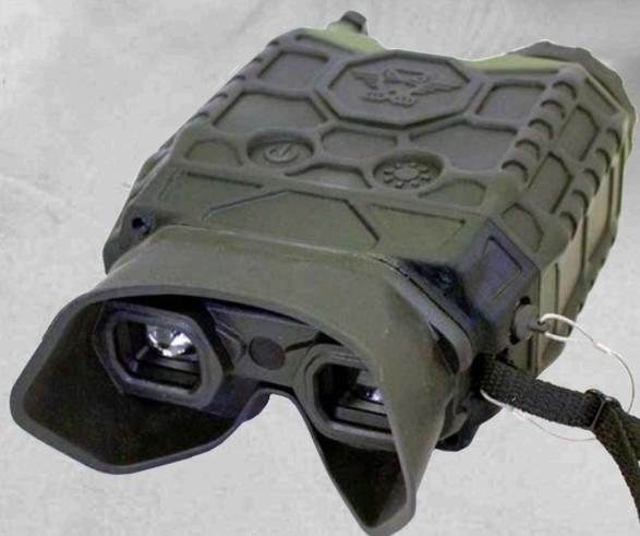
Прибор предназначен для дистанционного обнаружения оптико-электронных систем наблюдения (СН), в том числе ПНВ и снайперских прицелов (СП), снабженных длиннофокусными объективами, ведущих встречное наблюдение в условиях как интенсивного дневного, так и низкого ночного освещения.
